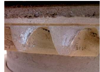
Şəkil 3. Rotorun aparıcı dişli çarxının (tacın) vəziyyəti
