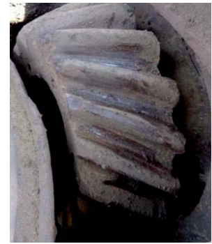
Şəkil 2. Rotorun aparıcı dişli çarxının vəziyyəti
