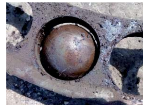
Şəkil 4. Əsas dayaq yastığının seperatoru və kürəciyinin işçi səthinin vəziyyəti
