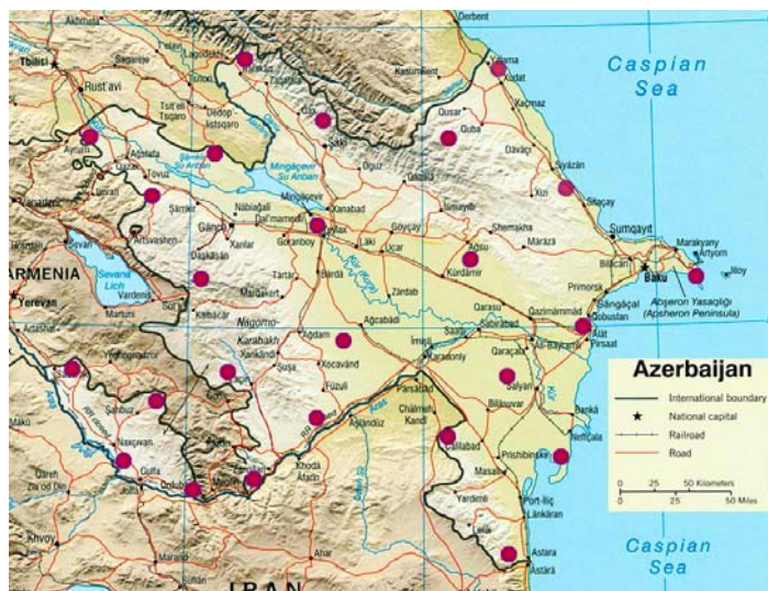
Рис. 10. Схема размещения предполагаемых базовых станций DGNSS в Азербайджане
