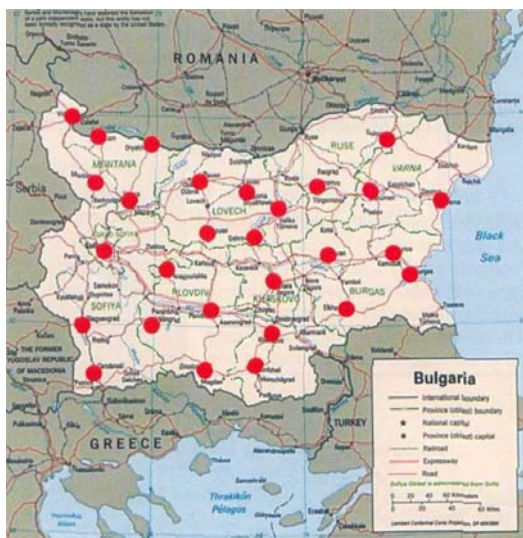
Рис. 9. Схема размещения базовых станций DGNSS в Болгарии
