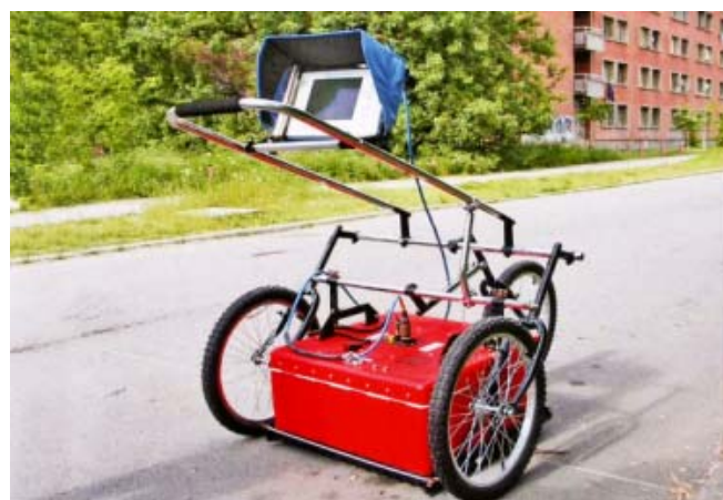
Рис. 5. Радар, проникающий в приповерхностный слой Земли
