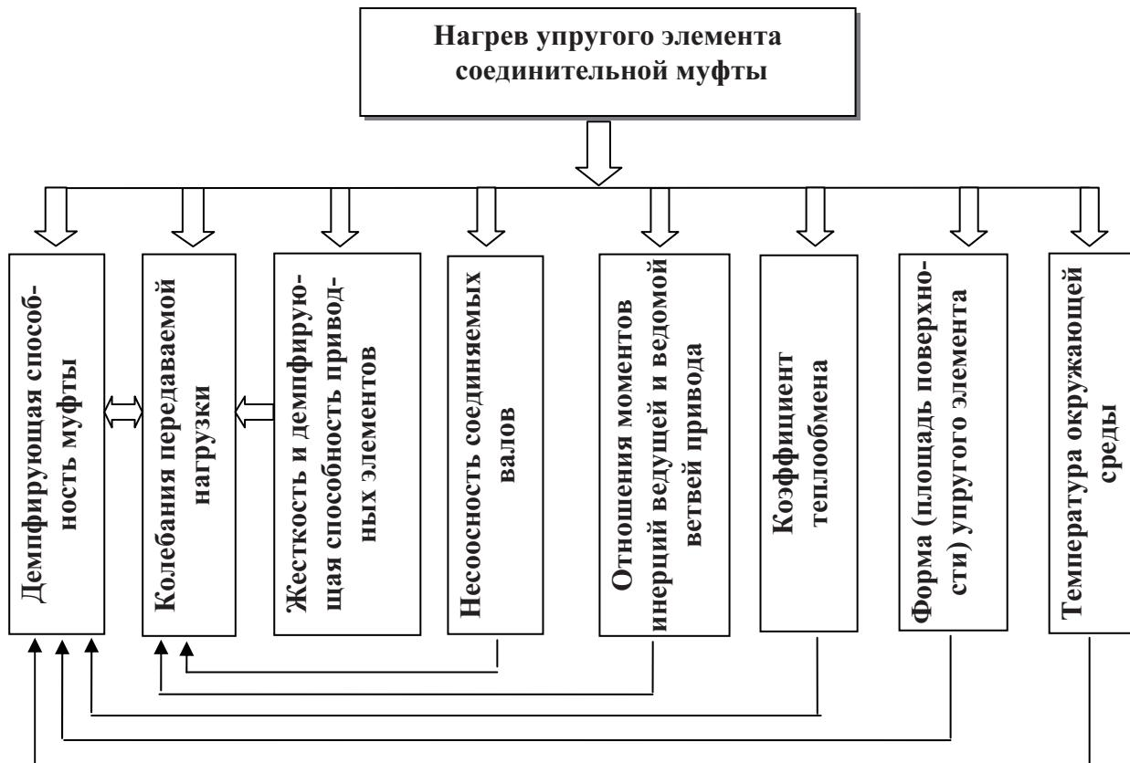
Рис. 1. Структурные зависимости факторов, влияющих на нагрев упругого элемента муфты
