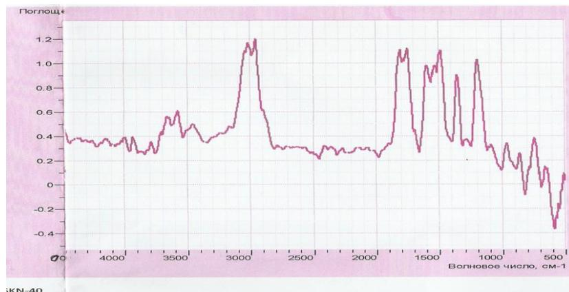
**Şəkil 1. BNK-26 markalı butadien-nitril elastomerinin İQ spektri**
