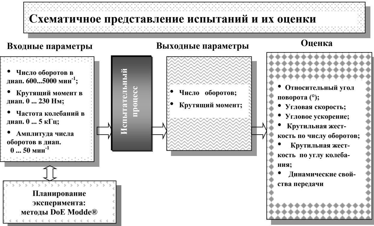
Рис. 4. Параметры ввода, измерения и обработки испытаний
