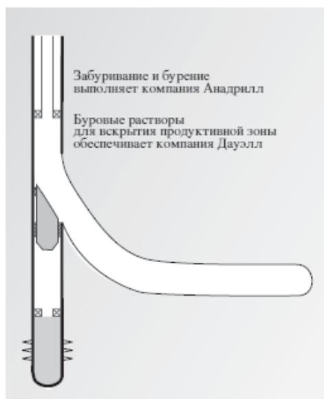
**Рис.1. Вариант заканчивания бокового ствола скважины открытым стволом в устойчивых породах типа известняков**
