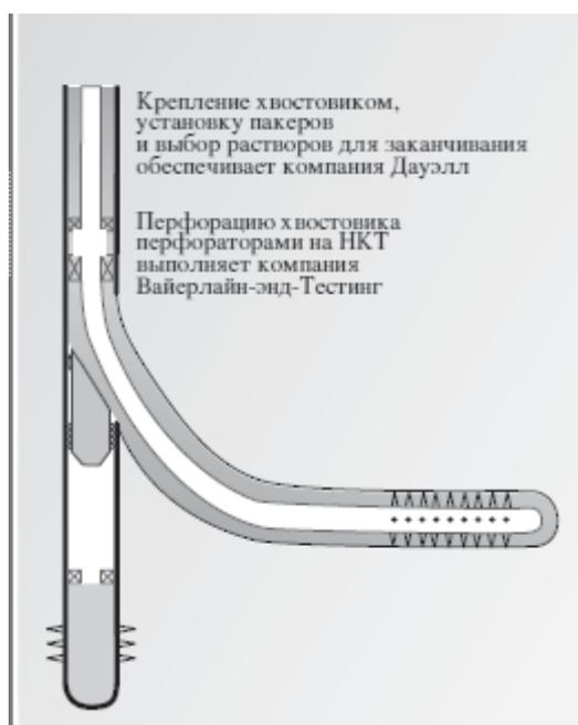
*Рис.2. Вариант заканчивания бокового ствола скважины колонной с цементированием и последующей перфорацией*
