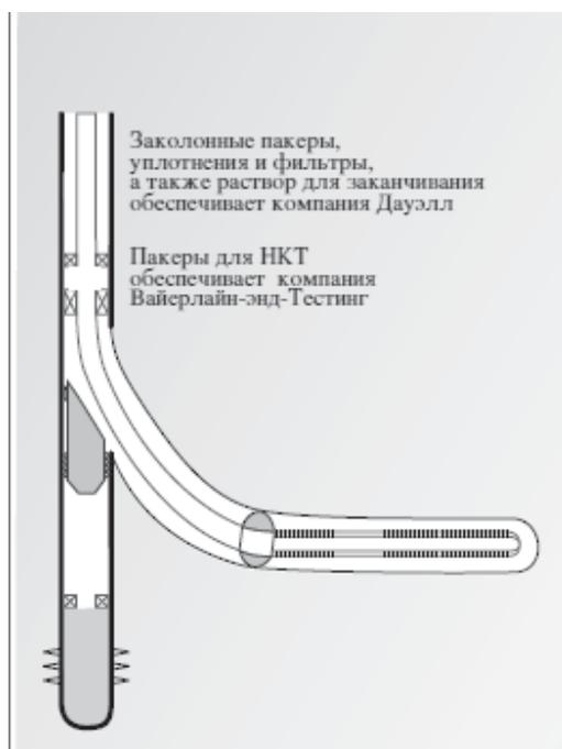
*Рис.3. Вариант заканчивания бокового ствола скважины с гравийной набивкой*
