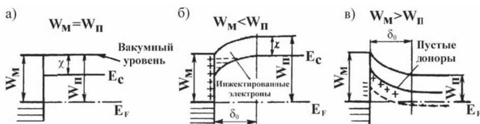
Рис. 9 а, б, в. Энергетические уровни взаимодействующих пар трения «металл-полимер» с различными типами контактов: а – нейтральный; б – омический или инжектирующий; в – блокирующий: E_C , E_F – энергетические уровни: критического движения, Ферми; W_M , W_{II} – работы выхода электронов и ионов из металла и полимера; \delta_0 – толщина обогащенного (б) и обедненного (в) электронами слоя; \chi – электронное сродство
