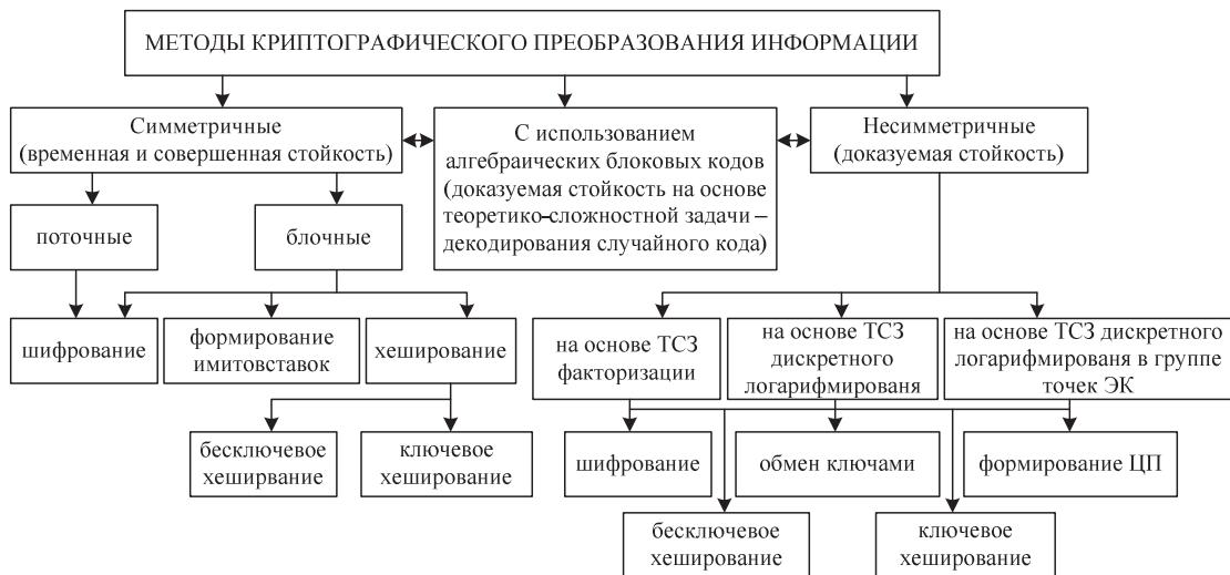
*Рис. 4. Общая классификация криптографических методов защиты*
