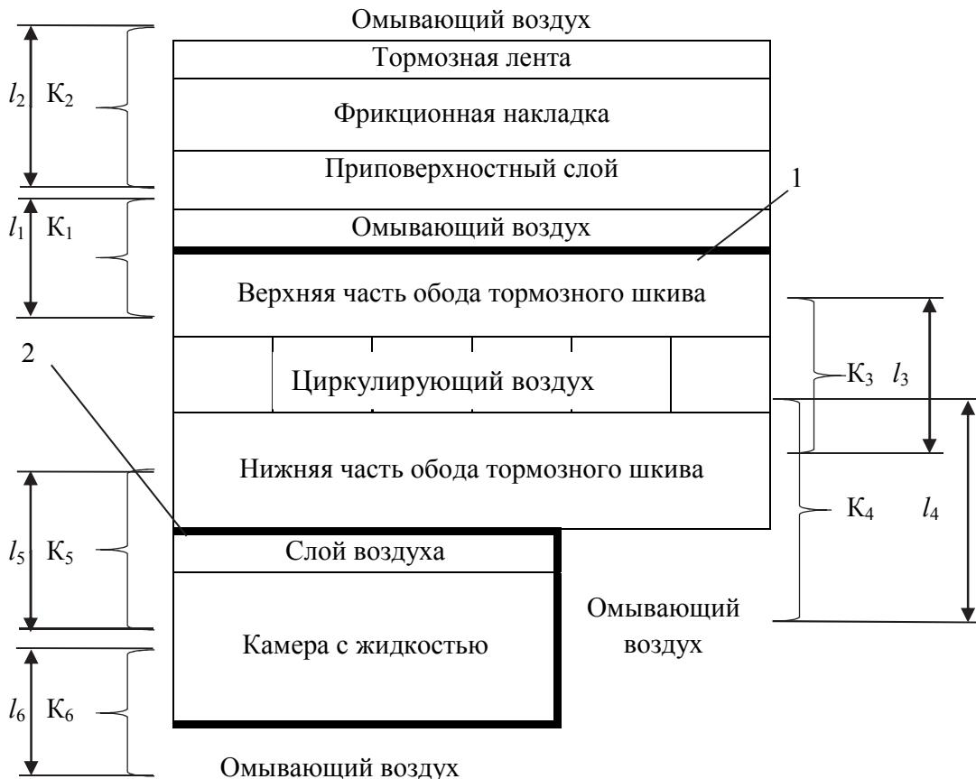
**Рисунок 4. Схематическая тепловая модель воздушно-жидкостной системы охлаждения фрикционных узлов тормоза: 1, 2 – полированные поверхности обода шкива: рабочая; нерабочая;  $K_i$  – коэффициент теплопередачи в теплообменных процессах через многослойные объекты**
