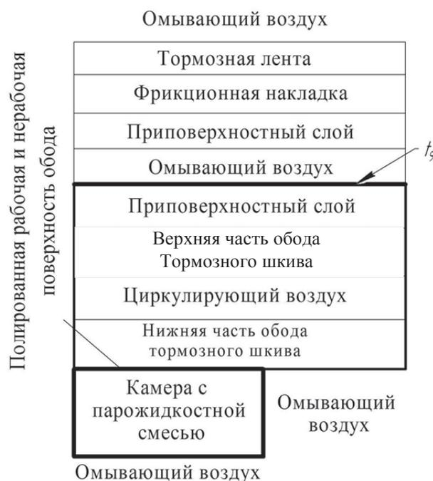
Рис. 1. Тепловая модель трибосистемы с воздушно-жидкостным охлаждением фрикционных узлов ленточно-колодочного тормоза
