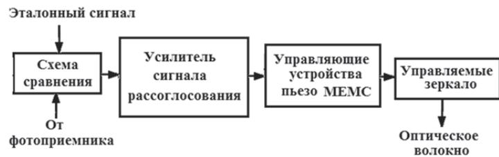
Рис. 4. Блок управления пьезоэлектрического коммутатора
