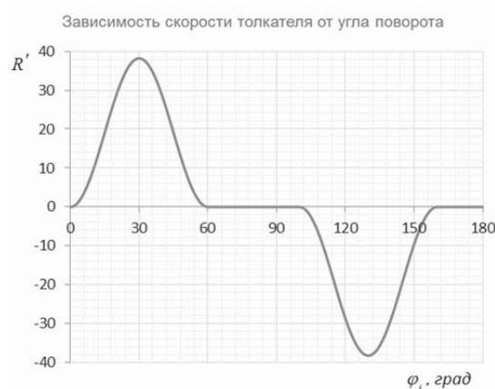
Рис.3. Зависимость скорости толкателя от угла поворота кулачка
