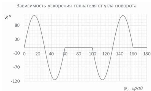
Рис.4. Зависимость ускорения толкателя от угла поворота кулачка
