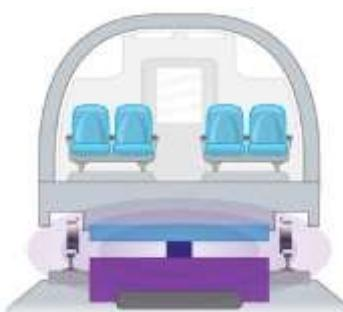
Şəkil 8 – Sabit maqnitli asqı sistemi
