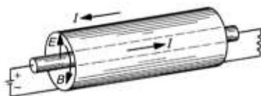
**Рисунок 5 – Коаксиальная линия:**  $E$  - напряженность электрического поля;  $B$  - магнитная индукция;  $I$  - электрический ток
