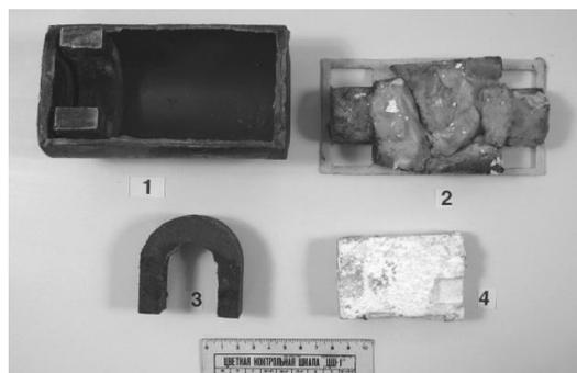
**Şəkil 1** – Partlayıcı qurğunun əsas hissələri (1 - partlayıcı qurğunun qutusu; 2 – partlayıcı maddənin enerji mənbəsi 3 – maqnit; 4- plastik partlayıcı maddə (C-4))
