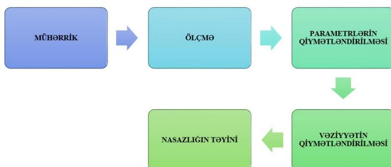
Şəkil 1 – Parametrlərin qiymətləndirilməsi əsasında mühərrik nasazlığının diaqnostikası
