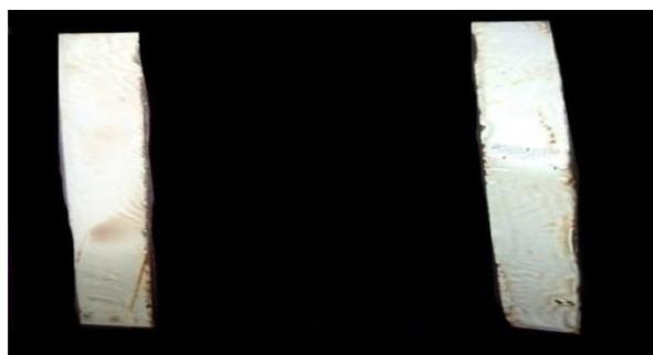
**Рисунок 3** – Фоторграфический снимок 180-дневных образцов эмали на основе талька (слева) и мела (справа)
